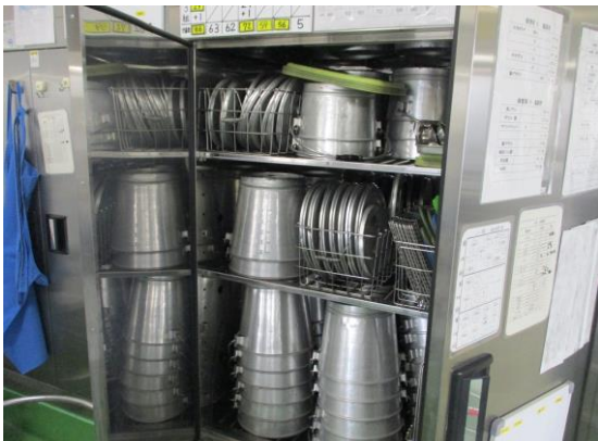
【保管庫①】洗われた食缶類は、さらに熱で消毒され、保管されています。
